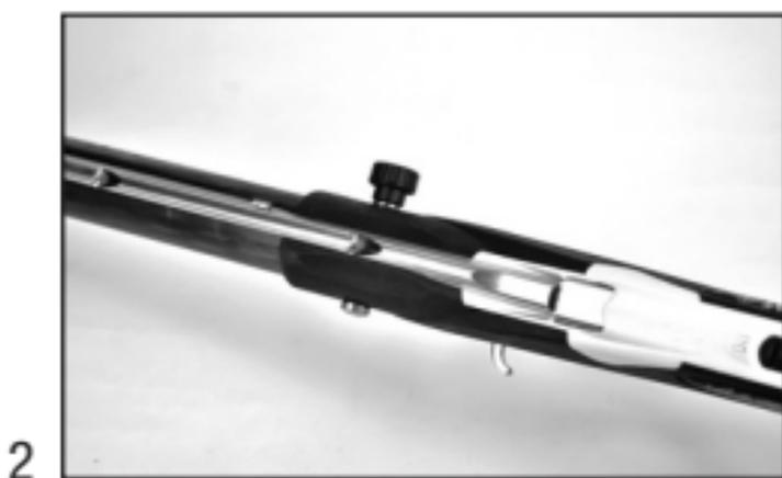
2 - Sostituire il perno o la vite con la vite inox in dotazione e serrarla con il volantino in nylon.
