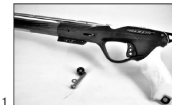
1- Estrarre il perno o la vite di tenuta dell'impugnatura con il fusto: questa operazione è possibile con molti fucili in commercio.
