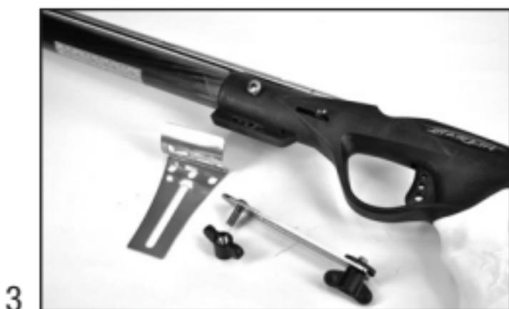
3 e 4 - Montare la staffa snodata: assemblare la staffa principale con il braccetto attraverso la vite ed il galletto nylon.
